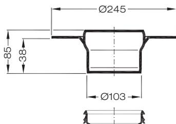
**Aufsatzelement mit Muffe**
